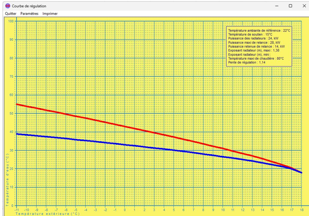
Affichage des pentes de régulation de la température, déterminée à partir des caractéristiques d'émission de chaleur des radiateurs, coefficient "m".
